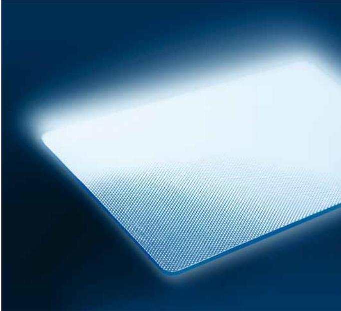
Das LGP koppelt seitlich eingebrachtes Licht durch integrierte Prismenstrukturen gleichmäßig über die Plattenfläche wieder aus. Die optisch wirksamen Strukturen stellen keine diffus streuenden Elemente dar, sondern nutzen Reflexion und Refraktion als grundlegende Prinzipien. Der direkte Lichtanteil ist im Allgemeinen entblendet.
